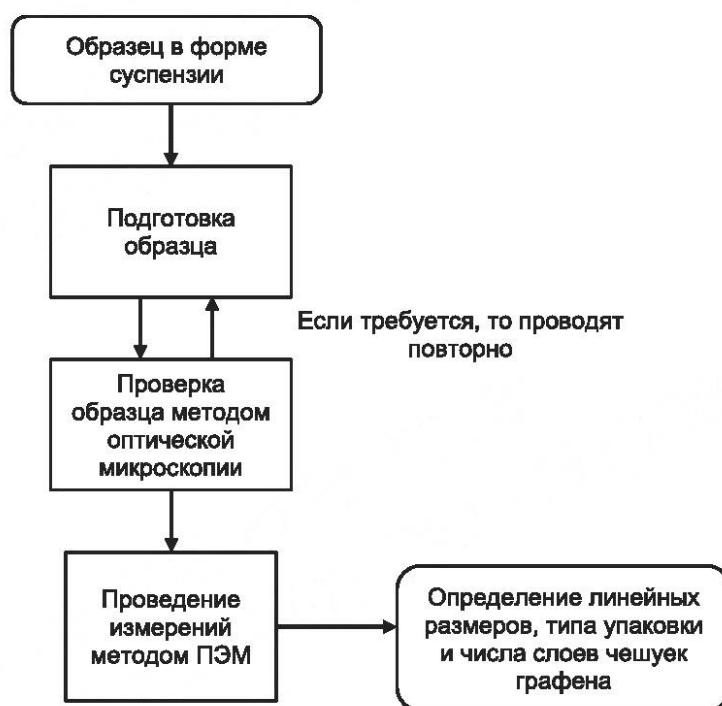
Рисунок 5 — Блок-схема (алгоритм) проведения измерений методом ПЭМ для определения линейных размеров, типов упаковки и числа слоев чешуек графена
