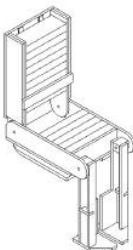
Рисунок D.4 — Деревянный испытательный манекен, конструкция, вид сбоку
