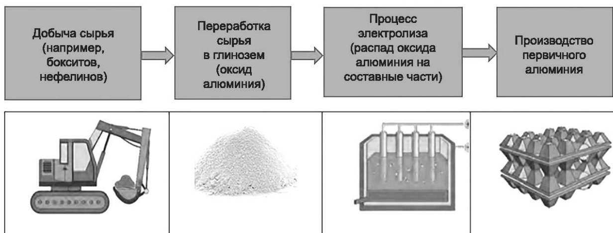
Рисунок 1 — Схема получения алюминия
