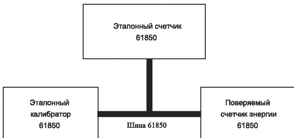
Рисунок В.1 — Схема испытательной цепи с применением калибратора для поверки однофазного ЦСч
