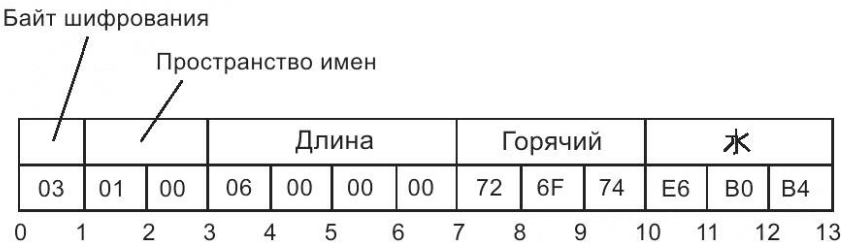
Рисунок 7 — Строковый NodeId, определяемый шифрованием и идентификатором
