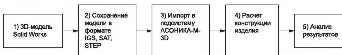
Рисунок А.7 — Схема по работе с подсистемой АСОНИКА-М-3D
