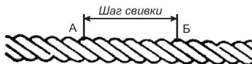
Рисунок Н.4 — Схема определения шага свивки шестипрядного каната
