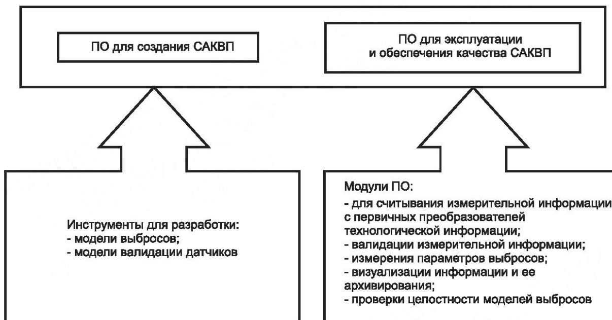
Рисунок 2 — Функциональная схема ПО САКВП
