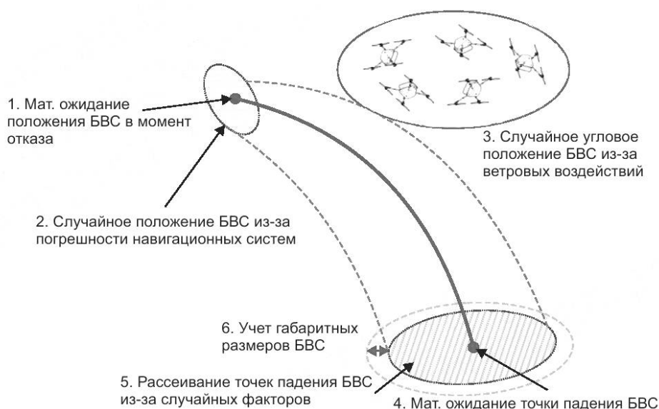
Рисунок Б.3 — Пример схемы моделирования последствий отказного состояния БВС
