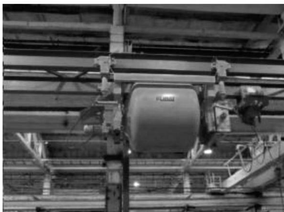
а) Кюбель для бетона
