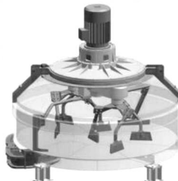
б) Смеситель с вертикальным расположением вала с планетарным вращением лопастей
