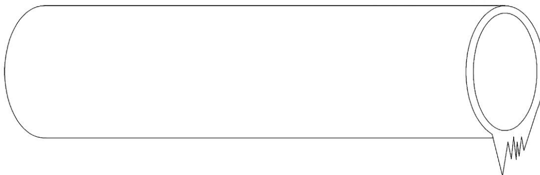
Рисунок 31 — Заусенец (см. рисунок Б.29)
