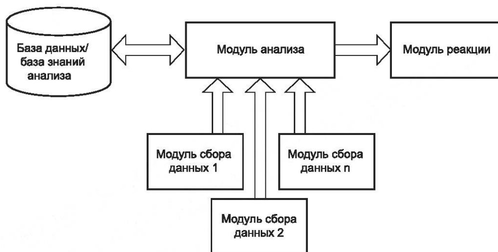
Рисунок А.1.2 — Модификация шаблона «Монитор», включающая несколько модулей сбора данных
