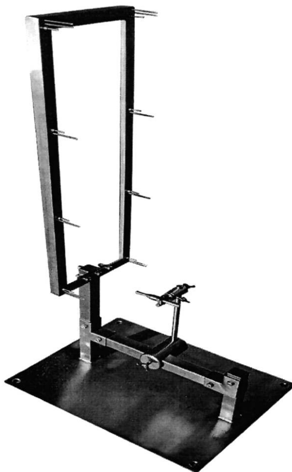
Рисунок Б.1 — Установка для определения скорости горения в вертикальной плоскости
