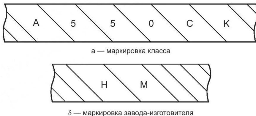
Рисунок Б.1 — Пример прокатной маркировки арматурного проката надписями
