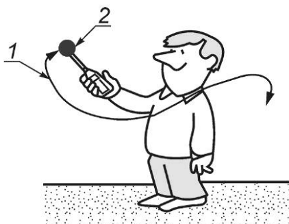
1 — движение акустического зонда при статическом методе измерения; 2 — акустический зонд
