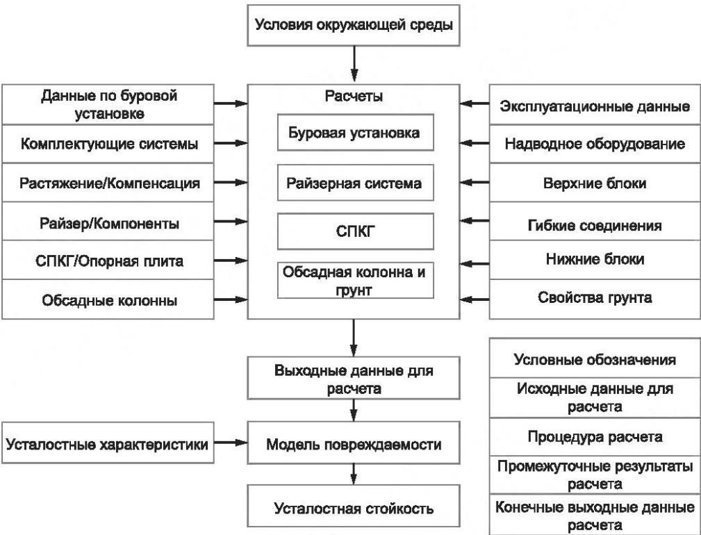
Рисунок 2 — Алгоритм расчета усталостной прочности СПКГ
