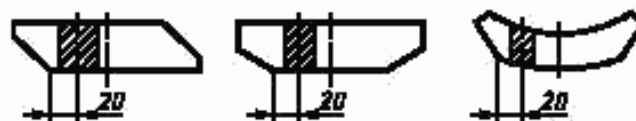
Рисунок В.3 — Схемы отбора заготовок из проб от полосы со скошенными кромками
