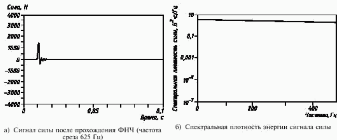
Рисунок 4 — Влияние низкочастотной фильтрации на сигнал силы и его спектр
