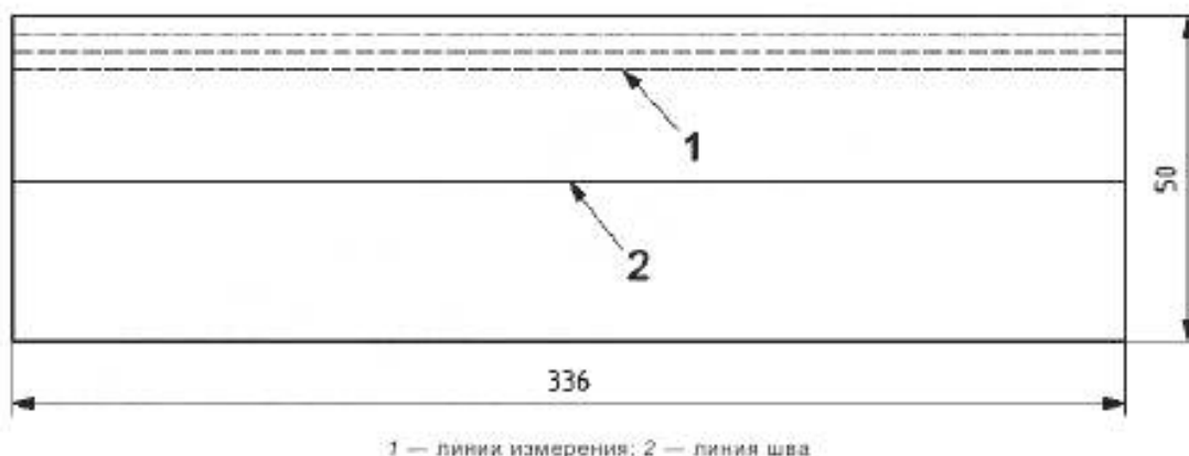
Рисунок А.2 — Область измерений эталона шва
