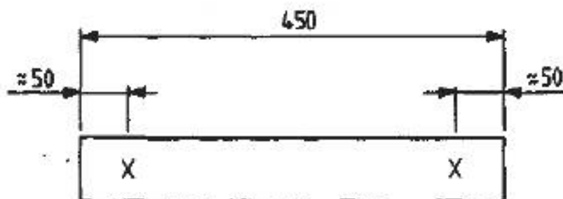
а) Маркировка образца, вырезанного из ткани (полотна), шириной менее 70 мм.
