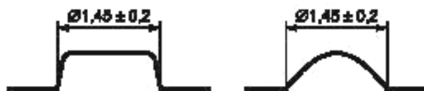
Рисунок 3 — Примеры формы и размер основания точек ТИ
