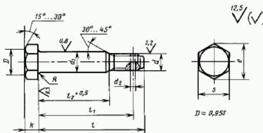
*Исполнение 2 (исполнение 2а — без отверстия под шплинт)*
