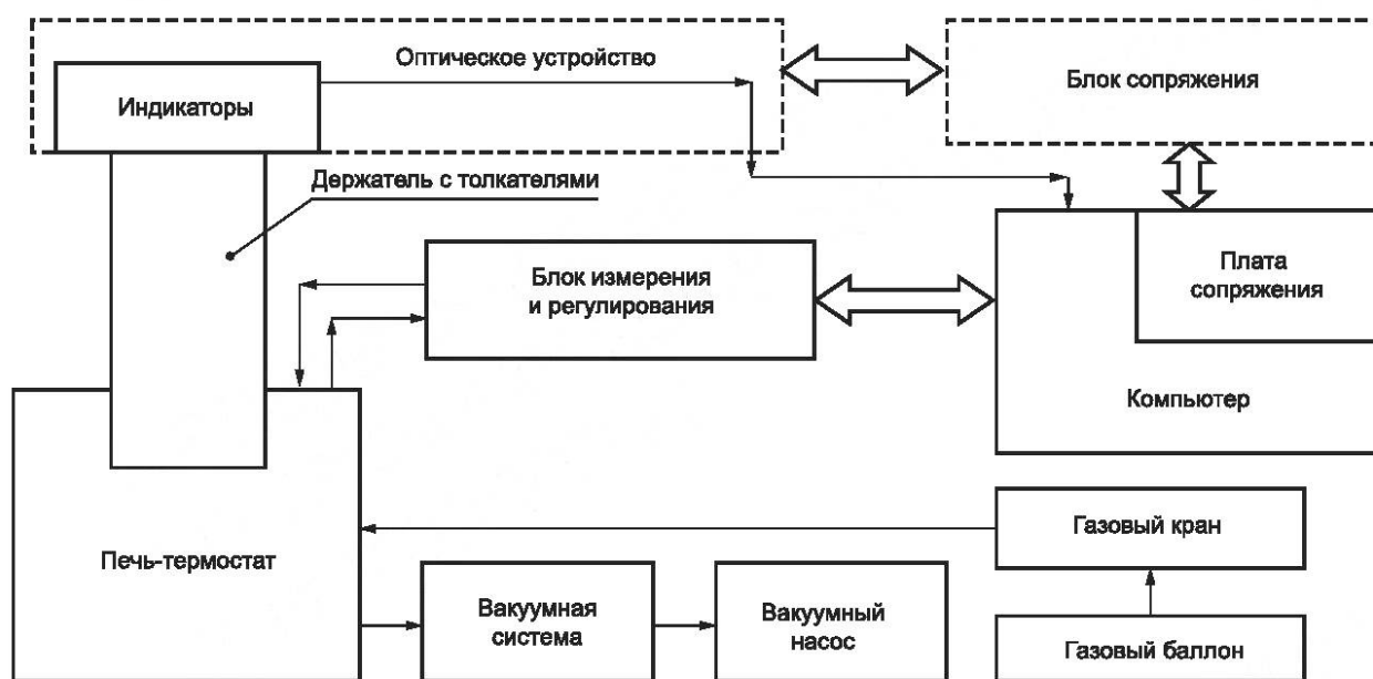
Рисунок Б.1 — Функциональная блок-схема ВДТ
