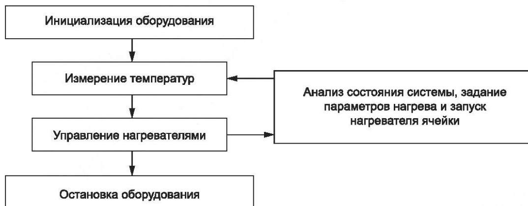
Рисунок Б.6 — Алгоритм управления оборудованием
