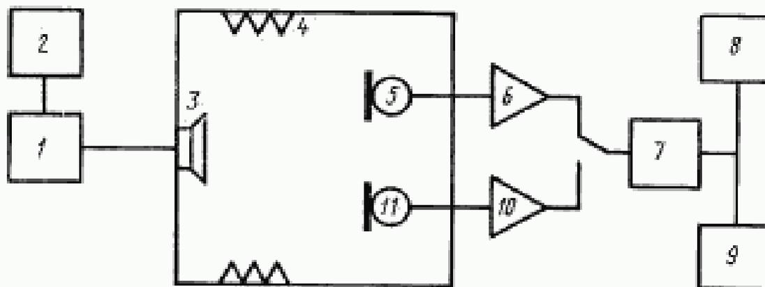
1—генератор; 2—частотомер; 3—громкоговоритель; 4—заглушечная камера; 5 и 11—образцовый и поверяемый микрофоны; 6 и 10—микрофонные усилители; 7—магазин затухания; 8—электронный вольтметр; 9—осциллограф.
