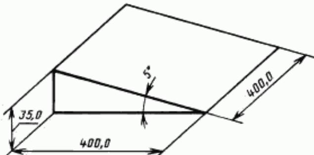
Приспособление представляет собой наклонную плоскость с углом наклона  $5^\circ$ , которое устанавливают на горизонтальной поверхности поверочного стенда или стола. Приспособление может быть изготовлено из любого металла (из алюминия или алюминиевых сплавов). Его собирают из отдельных элементов (пластины и боковых укосин) или отливают в виде полой детали. Наклонную поверхность обрабатывают соответствующим образом для придания ей плоскости.
