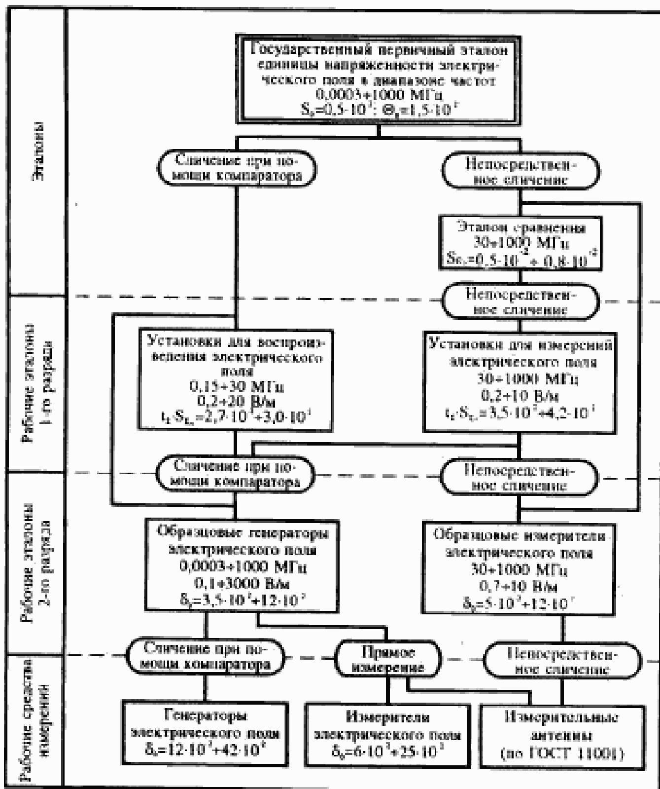
Ключевые слова: государственная поверочная схема, средства измерений, эталон, электрическое поле, измеритель электрического поля, генератор электрического поля, погрешность
