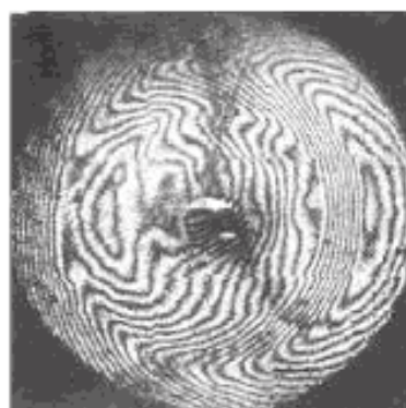
б) Наклонная юстировка
