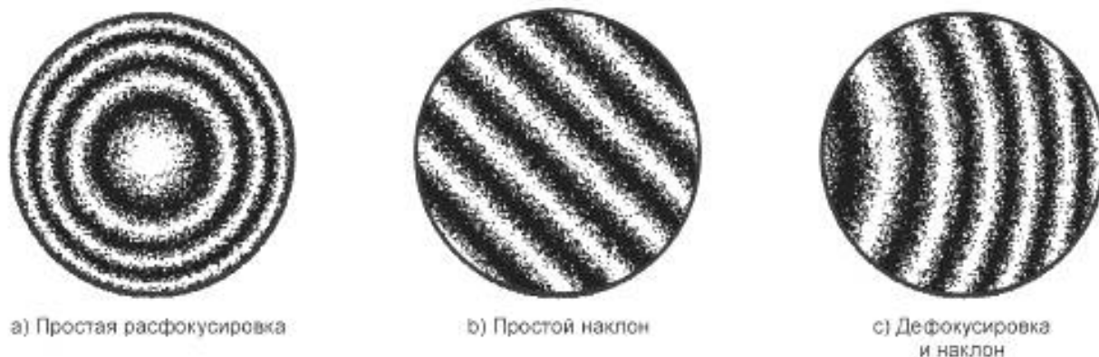
Рисунок 7 — Интерферограммы испытуемых объектов без заметных аббераций
