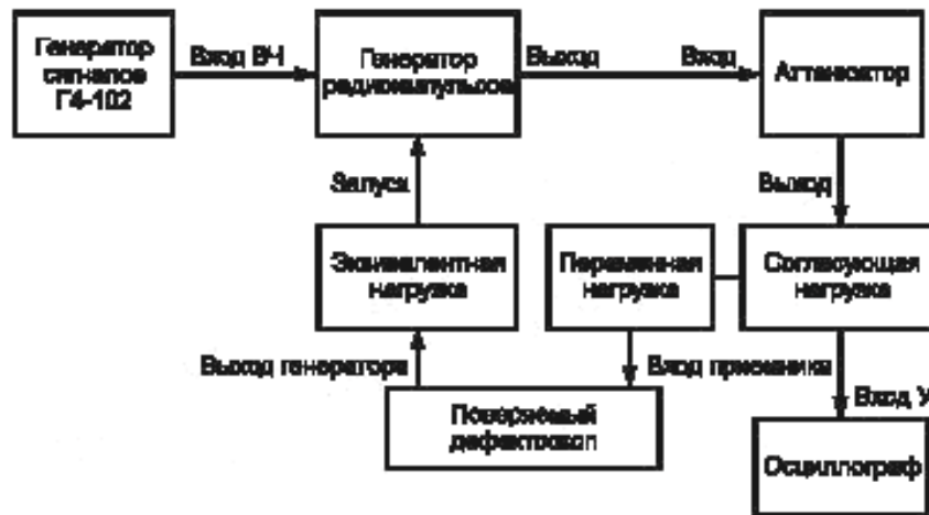
Рисунок 1 — Схема установки для поверки дефектоскопов
