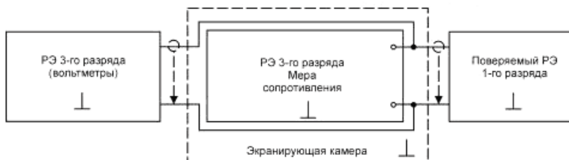
Рисунок 8 — Схема соединения приборов при проверке РЭ 1-го разряда [калибраторы (меры) тока и поверочные установки, работающие в режиме воспроизведения силы тока] в диапазоне от 1 \cdot 10^{-10} до 1 \cdot 10^{-9} А с помощью РЭ, заимствованных из других поверочных схем
