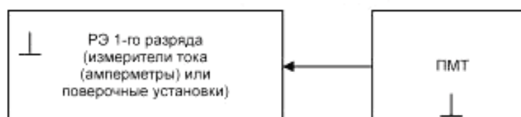
Рисунок 3 — Схема соединения приборов при поверке РЭ 2-го разряда и РСИ в диапазоне токов от 1 \cdot 10^{-15} до 1 \cdot 10^{-9} А на РЭ 1-го разряда, в качестве которых используют измерители тока (амперметры) или поверочные установки, работающие в режиме измерения силы постоянного тока
