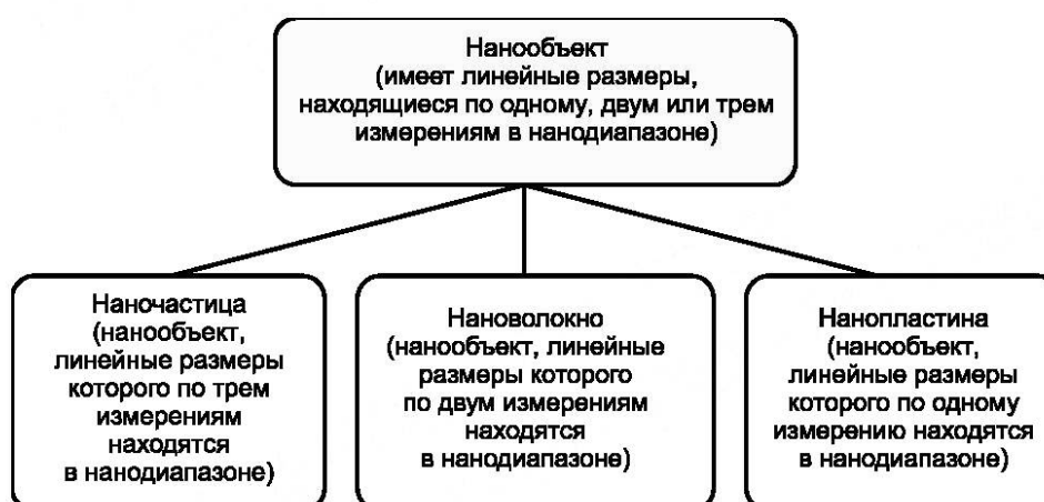
Рисунок 2 — Фрагмент иерархической взаимосвязи понятий, относящихся к нанобъектам
