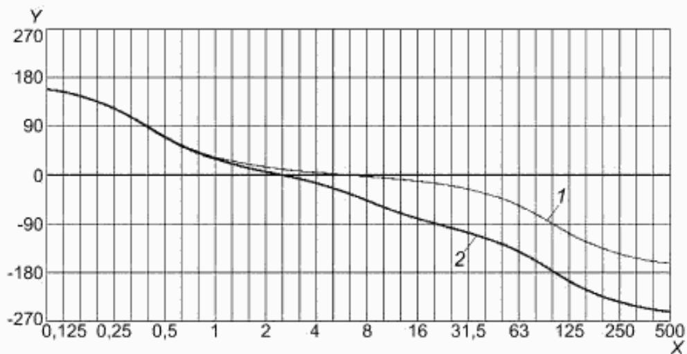
Рисунок В.3 — Модуль функции частотной коррекции W_c
