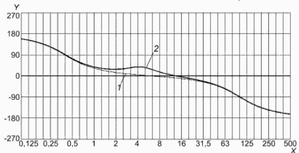
X — частота, Гц; Y — фаза, ...°; 1 — полосовой фильтр; 2 — функция частотной коррекции
