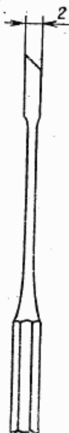
Рисунок 14 — Прямое долото со скошенным лезвием, левое —
