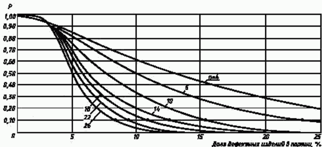
Р и с у н о к 5 — Кривые оперативных характеристик одноступенчатых планов контроля таблицы 9 для AQL = 2,5\% : с установленным односторонним пределом для отдельных единичных значений и известным средним квадратическим отклонением 1)
