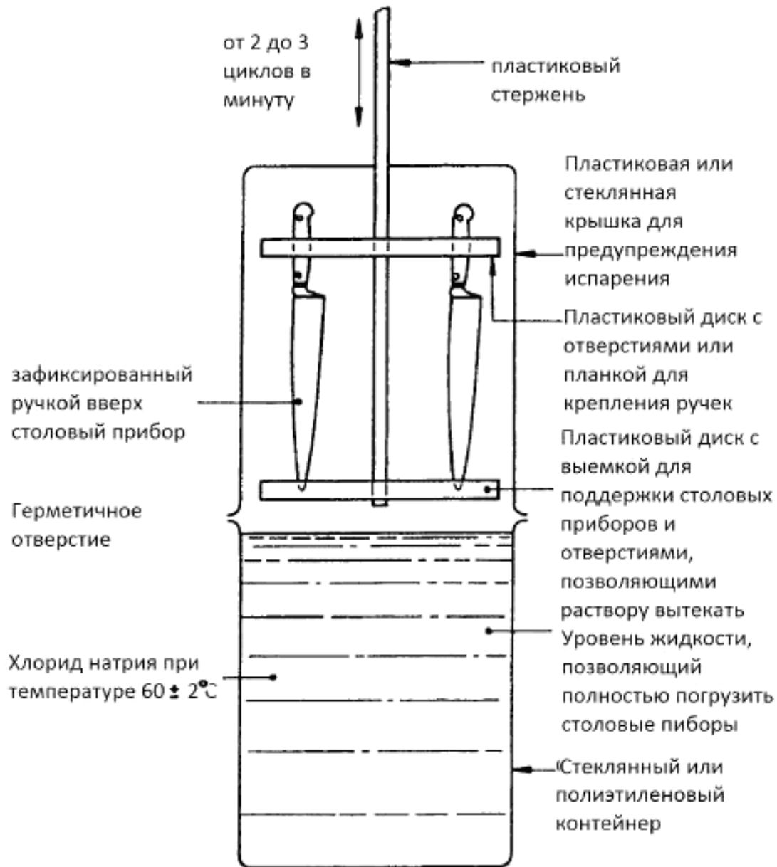
Рисунок В.1 - Оборудование для коррозионных испытаний
