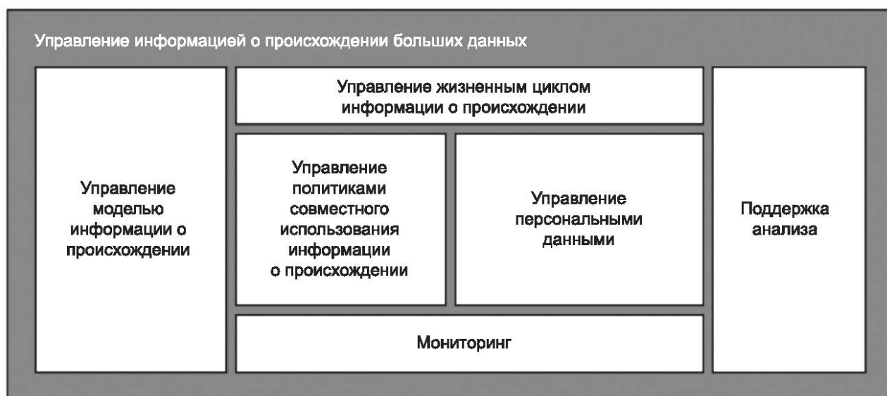
Рисунок 6.11 — Конфигурация логических компонентов для управления информацией о происхождении больших данных
