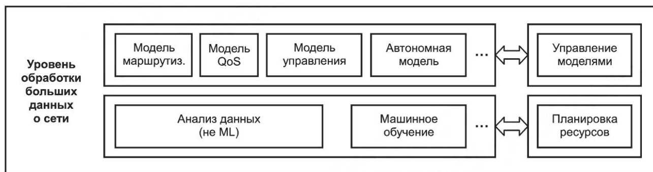
Рисунок 6.6 — Функциональная архитектура уровня обработки больших данных о сети
