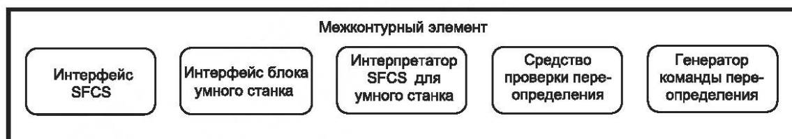
Рисунок 5 — Функциональная структура межконтурного элемента
