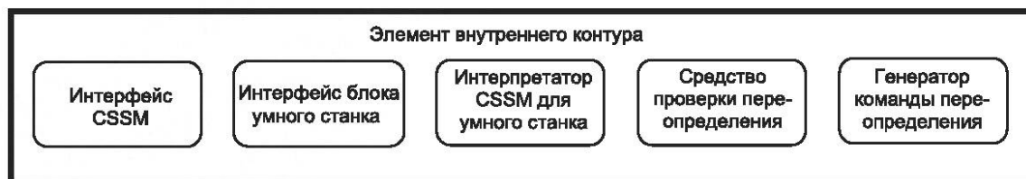
Рисунок 4 — Функциональная структура элемента внутреннего контура
