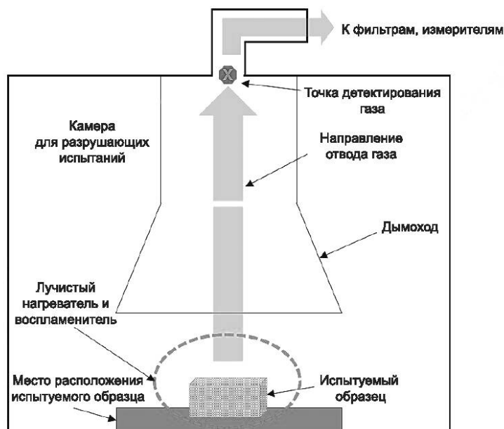
Рисунок 1 — Схема камеры, используемой для испытания отдельных аккумуляторов
