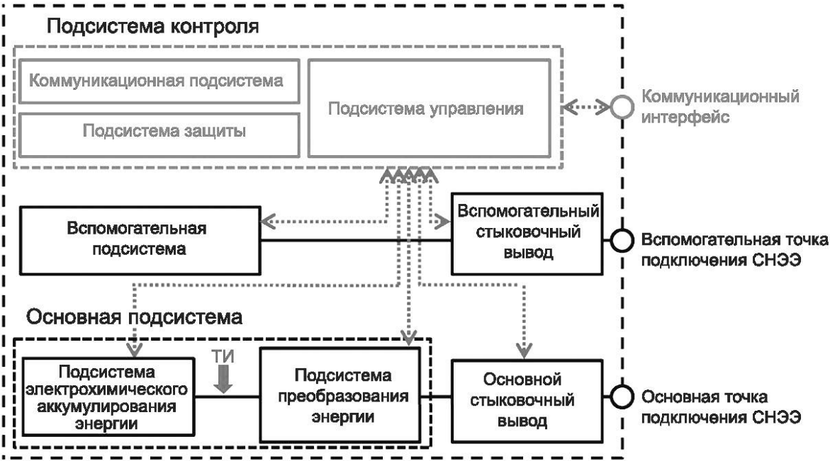
Рисунок 3 — Точка измерения кондуктивного излучения на ПЭППТ
