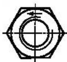
Рисунок 6 — Маркировка левой резьбы
