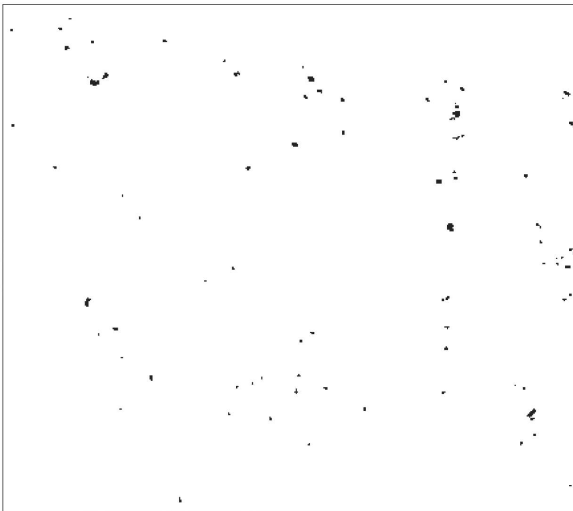
Рисунок Ж.2 — Коррозия металла балл К2 (или Ri 2)
