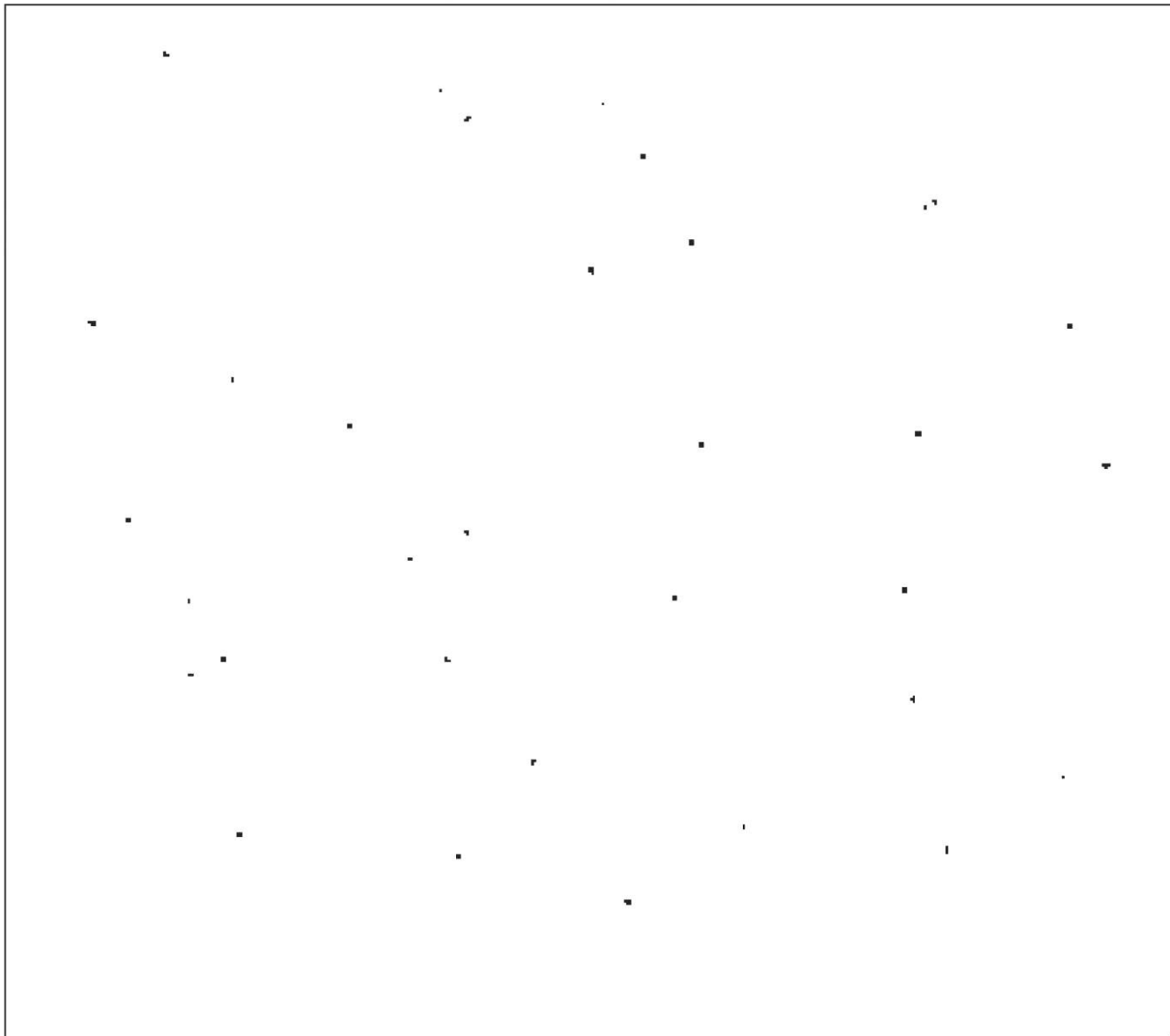
Рисунок Ж.1 — Коррозия металла балл K1 (или Ri 1)*
