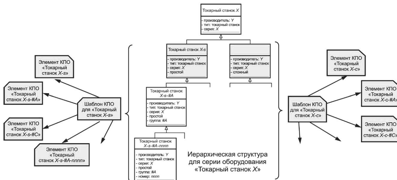
Рисунок А.2 — Элементы КПО, созданные с использованием шаблонов КПО для классов «Токарный станок X-s» и «Токарный станок X-c»
