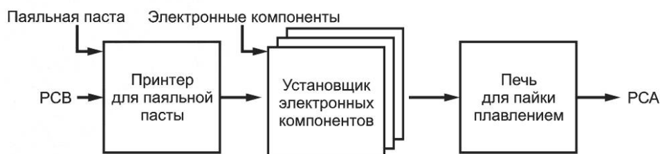
Рисунок Б.1 — Структура линии сборки печатных плат
