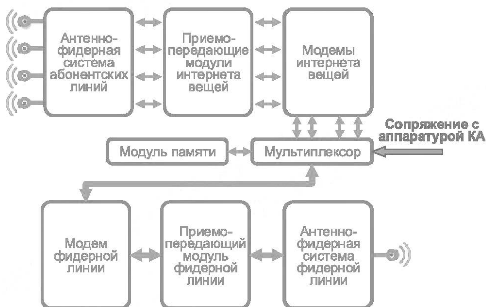
Рисунок 5 — Типовая архитектура полезной нагрузки космического аппарата
