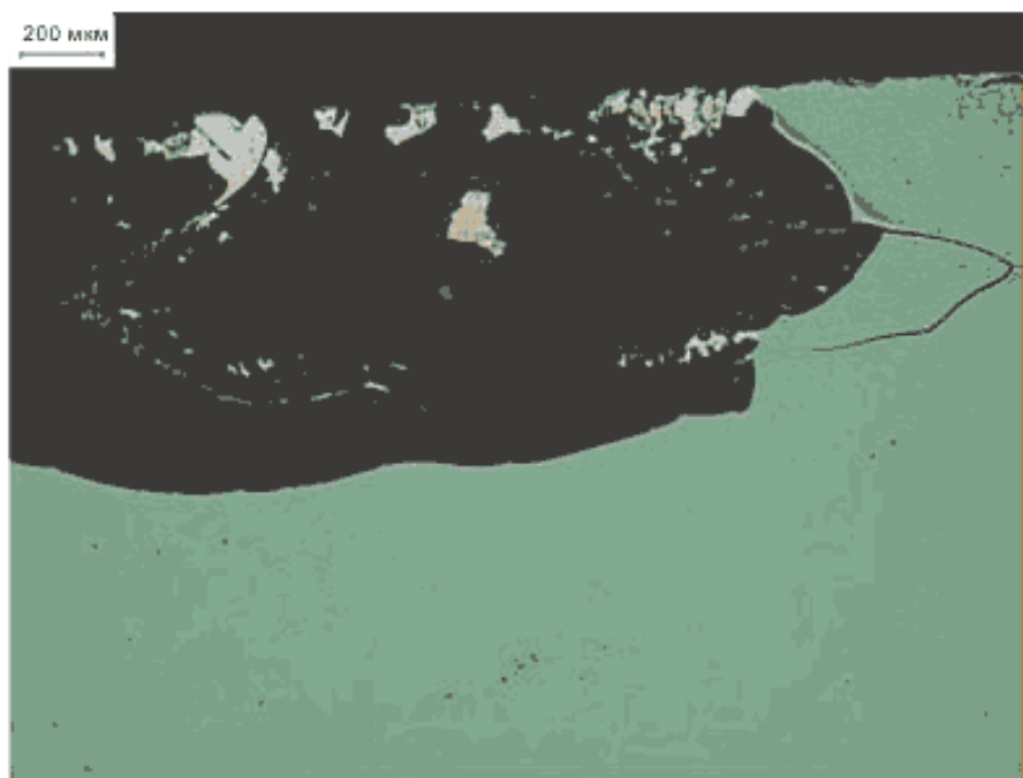
Рисунок А.14 – Отслаивание
