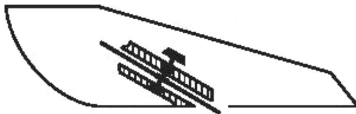
Рисунок А.2 — Пример ломтерезки для тонкой нарезки ломтиков сыра максимальной толщиной 1 мм (5.3)
