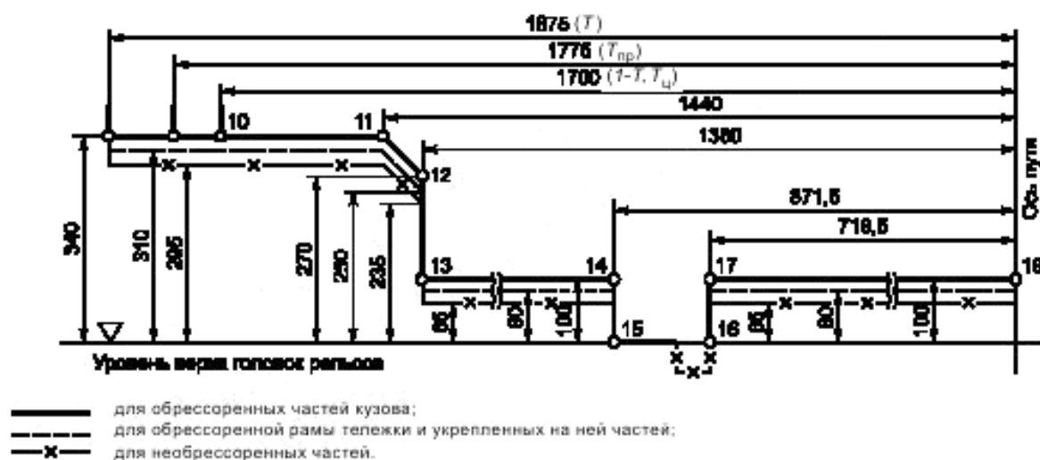
Рисунок 5 — Нижнее очертание габаритов для подвижного состава, не проходящего через сортировочные горки, оборудованные вагонными замедлителями
