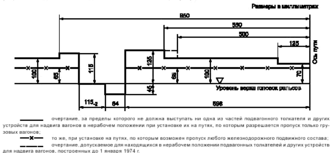
Рисунок 30 — Нижнее очертание для подвагонных толкателей и устройств надвига вагонов
