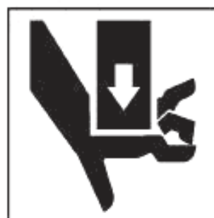
Рисунок А.22 — Раздавливание пальцев или кисти. Силовое воздействие сверху
