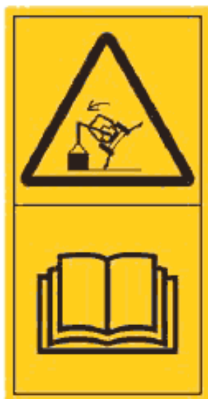
Рисунок С.32 — Опрокидывание машины или перегруз. Читай инструкцию по эксплуатации
