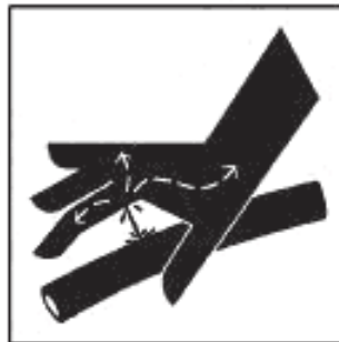
Рисунок А.9 — Жидкость под высоким давлением. Поражение тела от выброса жидкости
