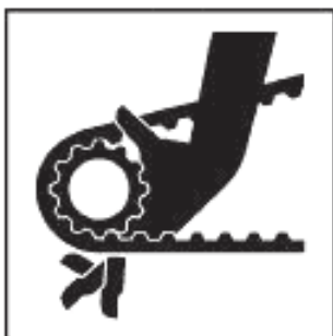
Рисунок A.29 — Затягивание кисти и руки. Цепной или зубчатый ленточный привод
