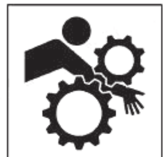
Рисунок A.31 — Затягивание кисти и руки. Вращающиеся шестерни
