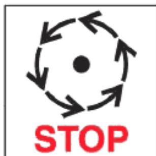
Рисунок В.12 — Не прикасайся к подвижным частям машины до их полной остановки
