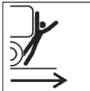
Рисунок D.21 — Пример иллюстрации со стрелкой, обозначающей направление движения машины в целом
