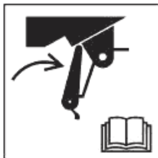
Рисунок В.10 — Установи блокирующее устройство перед входом в опасную зону. Читай инструкцию по эксплуатации
