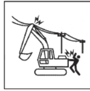
Рисунок А.6 — Электрошок или поражение электрическим током. Экскаватор
