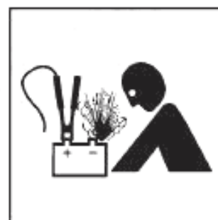
Рисунок А.45 — Взрыв аккумуляторной батареи при запуске двигателя от другого автомобиля
