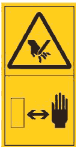
Рисунок С.21 — Травматическая ампутация пальцев или кисти. Держи руки на безопасном расстоянии от источника опасности
