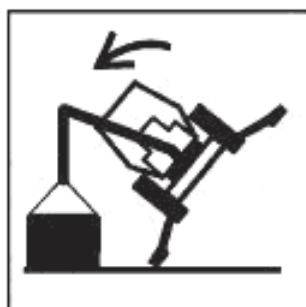
Рисунок А.41 — Опрокидывание машины. Перегруз. Экскаватор-погрузчик
