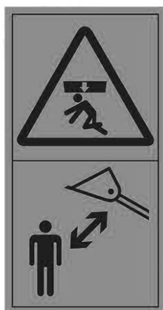
Рисунок С.2 — Раздавливание всего тела. Соблюдай безопасное расстояние от поднятой стрелы и ковша погрузчика
