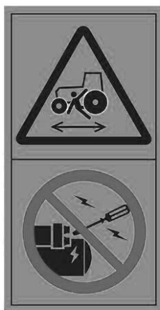
Рисунок С.11 — Опасность раздавливания. Риск наезда. Не запускай двигатель
