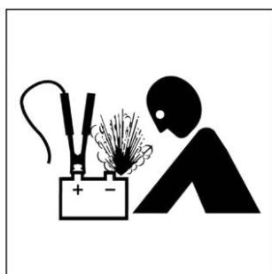
Рисунок А.45 — Взрыв аккумуляторной батареи. Запуск от внешнего источника
