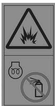
Рисунок С.20 — Опасность взрыва. Без эфира. Применяй устройство для холодного пуска
