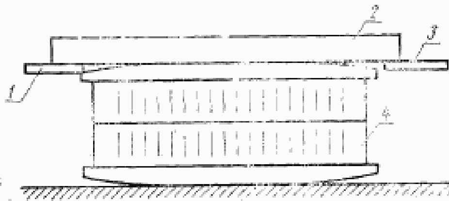
1 — щуп первый; 2 — поверочная линейка; 3 — щуп второй; 4 — блок
