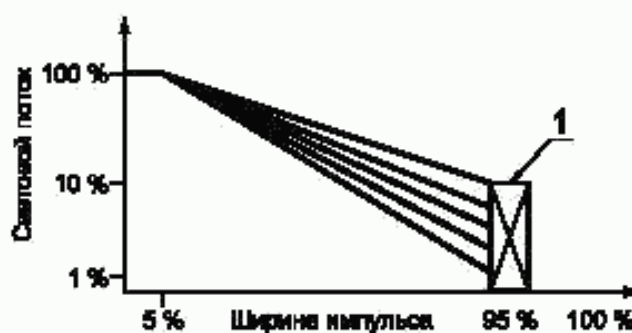
Кривая регулирования ПРА с минимальным световым потоком более 1 %
