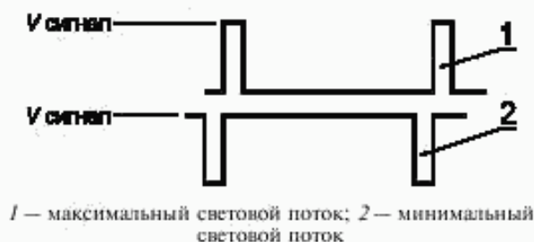
ШИМ сигналы для минимального и максимального светового потока
