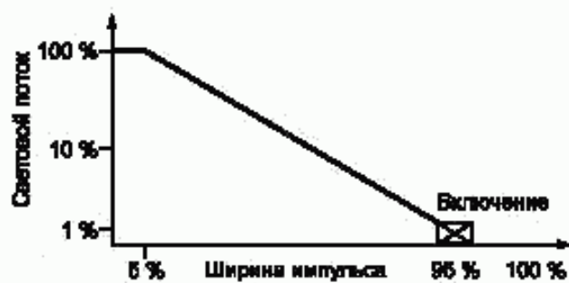
Кривая регулирования ПРА с минимальным световым потоком 1 %
